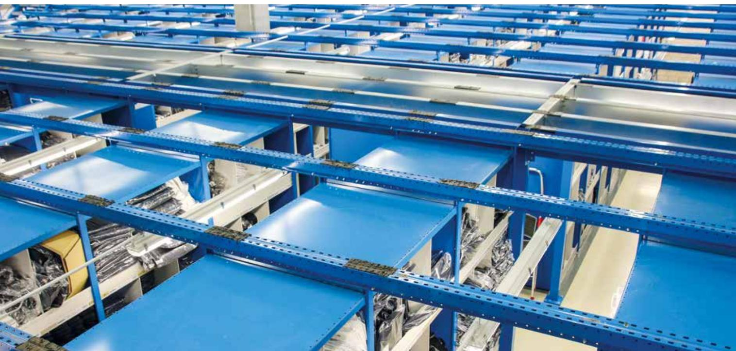
**Blick auf die LZN-Regalreihen: Die Artikel sind nicht nach Artikelart, sondern nach Bestellhäufigkeit sortiert. Die am häufigsten bestellten Artikel lagern beisammen. Laufwege werden reduziert, die Arbeitenden entlastet.**
