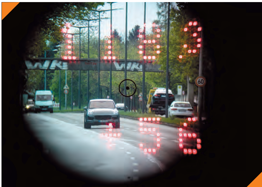
Im Sucher einer Laserpistole zur Geschwindigkeitsmessung ist die Entfernung eines heran-fahrenden Fahrzeugs und seine Geschwindigkeit zu sehen. Foto: Matthias Balk/dpa
