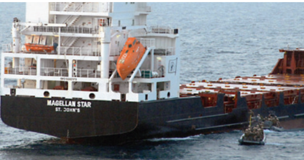
Einzelfahrer, oder Schiffe die – wie hier die Magellan Star – einen niedrigen Freibord (= Höhendifferenz der Bordwand zur Meeresoberfläche) aufweisen und dazu noch mit geringer Geschwindigkeit (unter 12 Knoten - kn [Seemeilen pro Stunde]) fahren, sind dankbare Opfer der Piraten. Foto: US Navy handout/dpa
