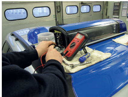
Reparatur der Sondersignalanlage.
