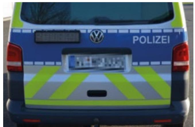
*Die Signal Beklebung mit der gelb fluoreszierenden Folie im „Chevron-Muster“ ist auch bei diesen Modellen vorbildlich.*
