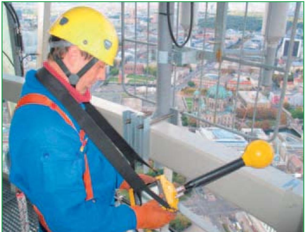
Festlegung von Sicherheitsbereichen. Sind es wirklich die Antennen für den digitalen Rundfunk (DAB), die den Hauptbeitrag zur Feldexposition leisten, oder sind es die UKW-Antennen mehrere Etagen höher? Auskunft gibt eine selektive Messung mit SRM-3000, dem Selective Radiation Meter von Narda Safety Test Solutions.
