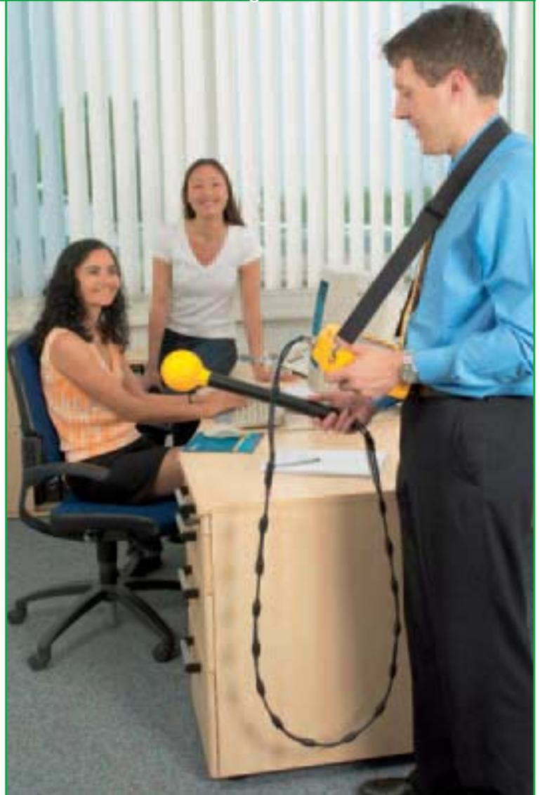
Übersicht über die Immissionen im Büro. Wenn die isotrope Messantenne über ein Kabel mit dem Grundgerät verbunden ist, lässt sich leicht die elektromagnetische Feldstärke in Arbeitshöhe abtasten.
