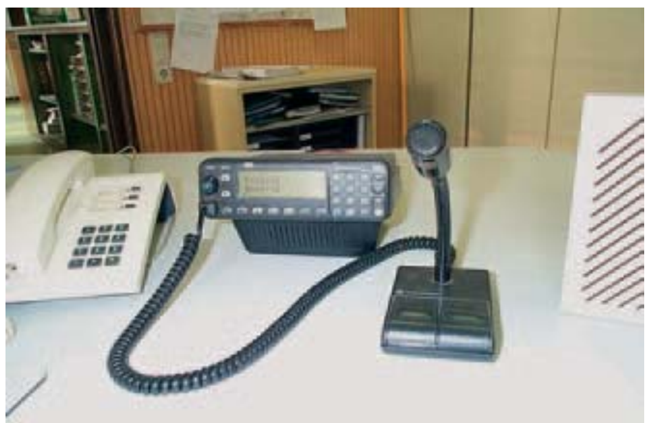
Fixed Radio Terminal - Bedienereinheit für Digitalfunk auf einer Wache
