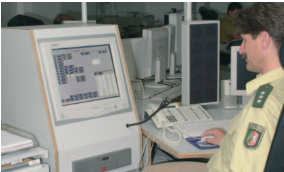
Fahrbare Schnittstelle. Der Computer mit der Funkeinheit kann an verschiedenen Arbeitsplätzen innerhalb der Leitstellen oder im Nachbarraum für eine separate Befehlsstelle angeschlossen werden
