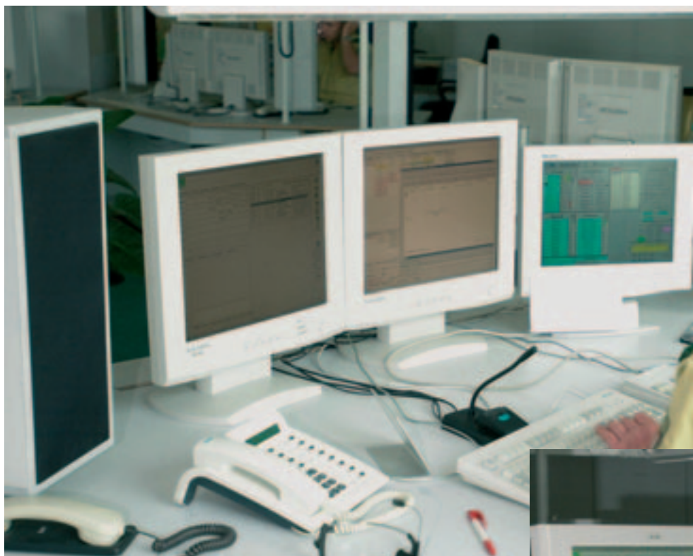
Drei Bildschirme (Flatscreen) auf einem Einsatzleitplatz im PP Aachen. Die beiden großen Bildschirme werden hauptsächlich für CEBIUS benutzt (sowie Datenabfragen, Online-Halter, Online-EMA, Statusübersicht). Weiterhin wird über diesen Rechner die Intranetanbindung realisiert, Formularverwaltung und eine gefilterte Internetverbindung für Online-Anfragen Telefonnummern. Der kleine Bildschirm NORUMAT beherbergt die visuelle Oberfläche für Kommunikation (Funk, Telefon, Hausalarm) mit einer kleinen Datenbank für Telefonnummern. Für diesen kleinen Bildschirm existiert eine separate Maus und eine spezielle Tastatur
